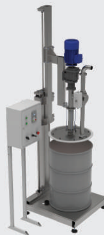
СРБ-02 – система разгрузки бочек (насос опускается в бочку с помощью пневмопривода)
