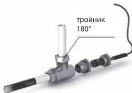
Рис. 2 - Схема прямого ввода нагревательной секции внутрь трубопровода
