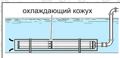
пример установки насоса в защитный кожух
